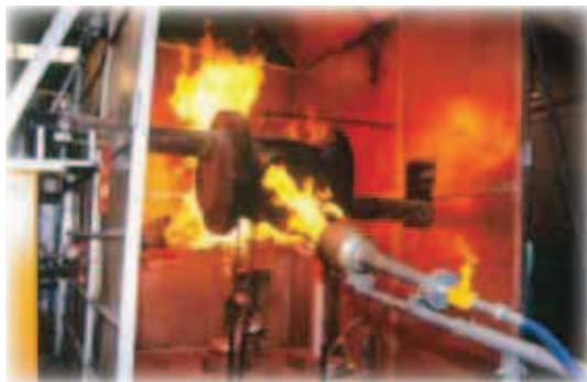
Instalación para válvulas sometidas a fuego bajo requerimiento del API durante un periodo de 30 minutos a flama directa y a una temperatura de entre 761 a 980°C. Pruebas certificadas por South West Research Institute.
